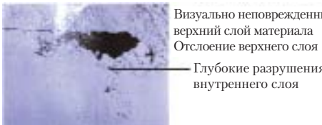
рис. 14Микрофотография межкристаллитной коррозии алюминиевого
